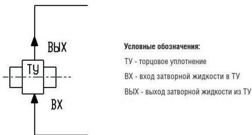
Рисунок 3 - Схема обвязки двойных торцовых уплотнений 52
